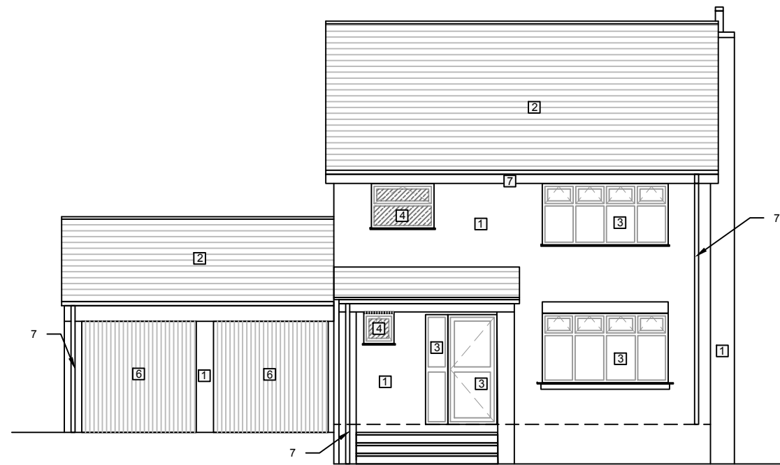
1 Existing Front Elevation - West Scale: 1:100 @ A3
