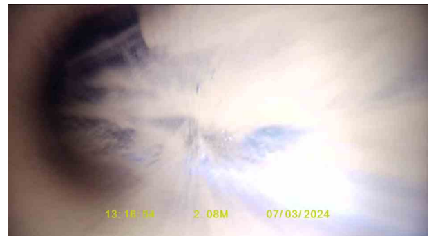
RWDP 5X_68404e3f-23d1-4bb0-ab65-89829c7d6252_20240320_085 048_607.jpg, 00:00:58, 2.08 m Line deviates left
